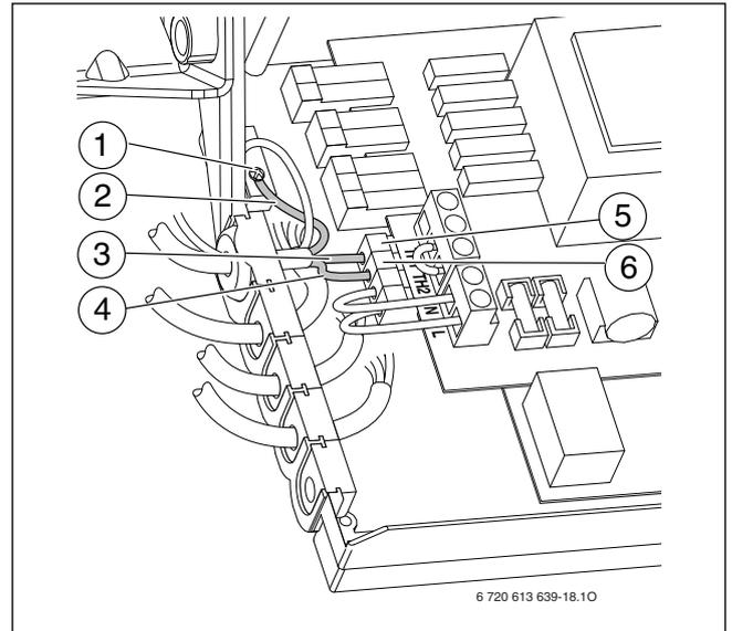
Рис. 18 Підключення мережевого кабелю 230 В 3С
