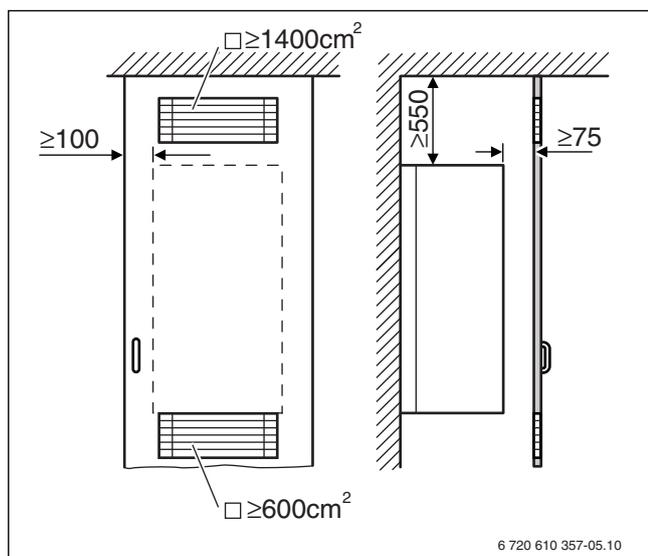
Рис. 8 Вентиляційні отвори під час монтажу в шафі
