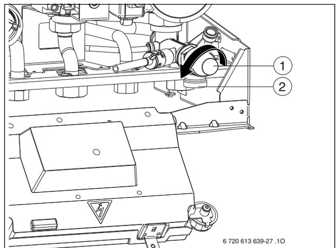
Рис. 43 Запобіжний клапан
