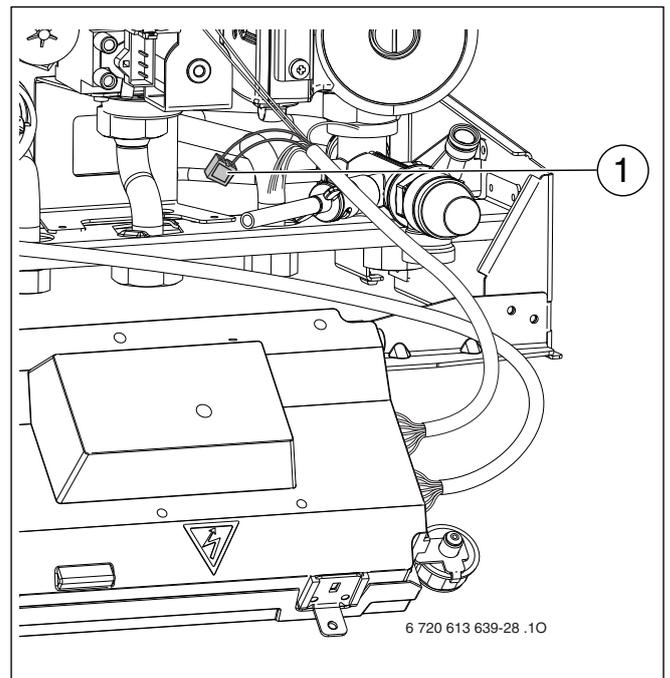
Рис. 19 Підключення температурного датчика бойлера (NTC)
