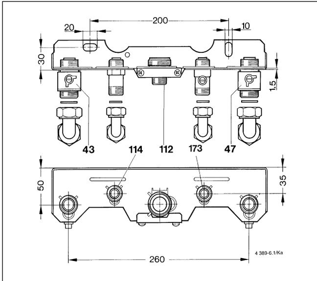
Рис. 10 Монтажна панель для підключення трубопроводів (допоміжне обладнання)
