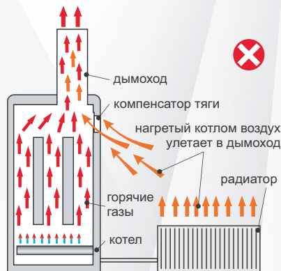
Схема работы обычного котла
